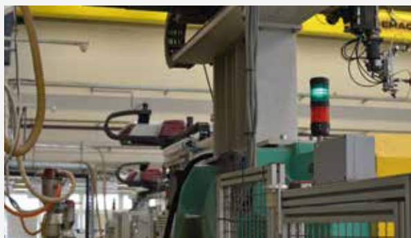
Pfannenberglub Wieża sygnalizacyjna BR 50 dla bezpieczeństwa maszyny
